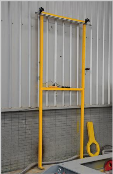
下刀量采用旋转编码器检测，精度高，同时可任意设定上、下行程位置，减小人员劳动强度。
